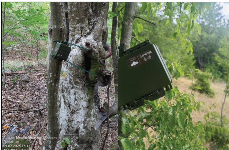
Карта 1. Ултразвуков детектор за прилепи, модел – Wildlife Acoustic – Song Meter Mini Bat 2
